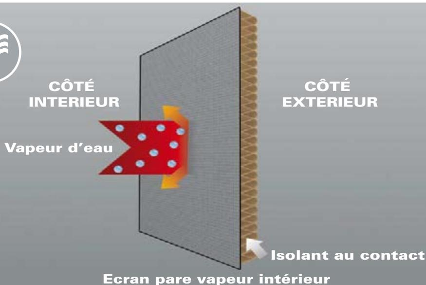
L'étanchéité à l'air des bâtiment est un point clé de la RT 2012. Il convient de choisir un film « frein vapeur » (notamment en Maison Ossature Bois) ou un pare vapeur selon le coefficient Sd désiré.
