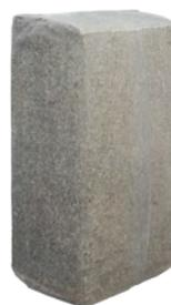
Ce ballot de 200 litres permet la réalisation de béton de chanvre sur chantier pour les éventuelles reprises. Le liant à utiliser est le Ciment Naturel Prompt Vicat.
