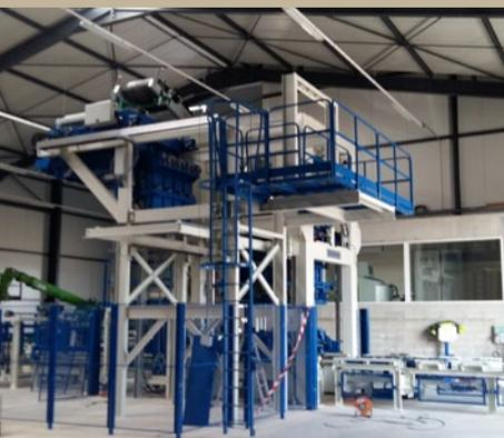
Une usine entièrement neuve a été construite pour fabriquer exclusivement les blocs de béton de chanvre qui composent le système constructif BIOSYS.
